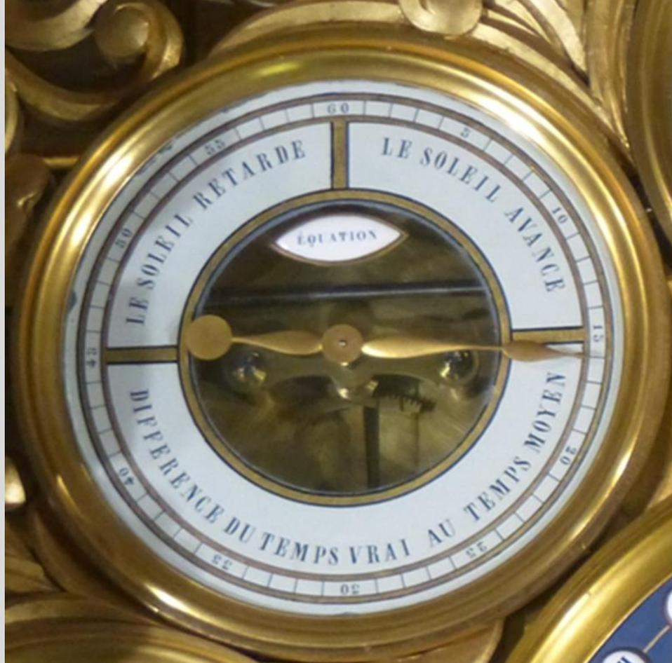
L'aiguille de ce cadran se déplace sur la partie supérieure du cadran de 45 à 15
