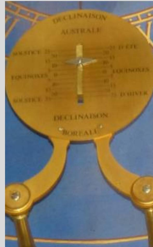
Cadran permettant de prévoir les éclipses solaires (Lune entre la Terre et le Soleil) et lunaires (Terre entre le Soleil et la Lune)
